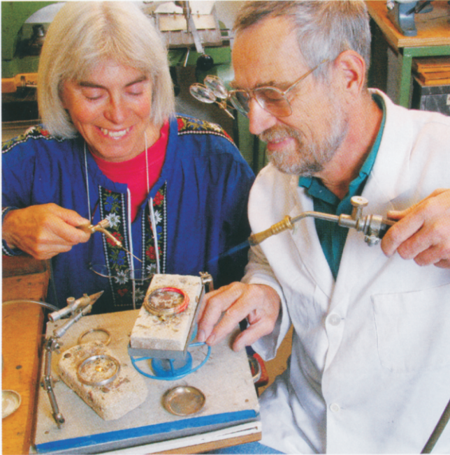
Uhrmachermeister Ulrike und Robert Ferstl beim Verlöten des Mittelteiles für ein neu gefertigtes Taschenuhrgehäuse
