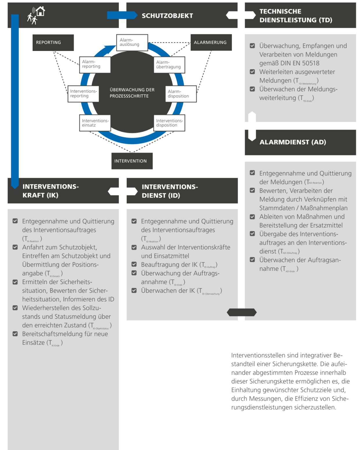
Interventionsstellen sind integrativer Bestandteil einer Sicherungskette. Die aufeinander abgestimmten Prozesse innerhalb dieser Sicherungskette ermöglichen es, die Einhaltung gewünschter Schutzziele und, durch Messungen, die Effizienz von Sicherungsdienstleistungen sicherzustellen.
