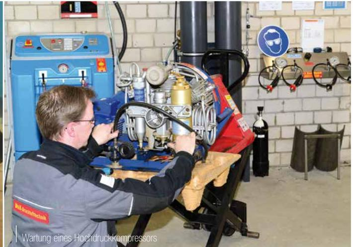
Wartung eines Hochdruckkompressors
