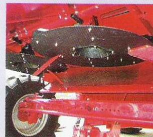
Kabine heraus (schwenkt die Bleche bei Seitenwind) ist optional lieferbar. Die serienmäßigen Verteilerteller werden auf der Oberseite mit neuen, speziell geformten Wurfschaufeln und auf der Unterseite mit jeweils 2 Spreuschaufeln bestückt. Zur Schwadablage werden 2 neue Kegel mit glatten Tellern und 2 Strohleitbleche aufgesteckt.
