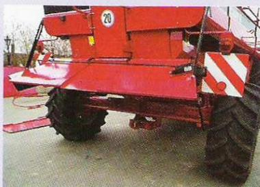
Die Kombi-Haube wird als Nachrüstsatz für Case IH Axialfluss Mähdrescher 1660/80, 2166/88 und 2366/88 angeboten. Sie ist in der Neigung stufenlos verstellbar, die seitlichen Begrenzungsbleche lassen sich ebenfalls, je nach Schneidwerkbreite, variabel einstellen. Eine elektrische Seitenblechverstellung aus der
