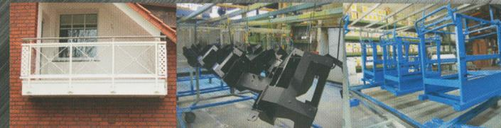
Nach der Verzinkung wurde dieses Brüstungsgeländer in RAL 9010 pulverbeschichtet (Duplex-Verfahren).
