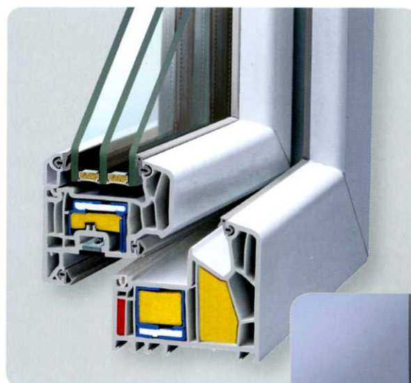
↑ Abb. GAYKOPASSIV MD90 mit optionalem Dämmkeil, in der Ausstattung 500PLUS, flächenversetzt (V) U_w : 0,73 W/(m²K) U_g : 0,5 W/(m²K)
