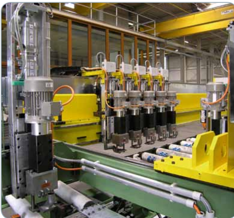
Bohrautomat mit 12-Servo-Achsen
