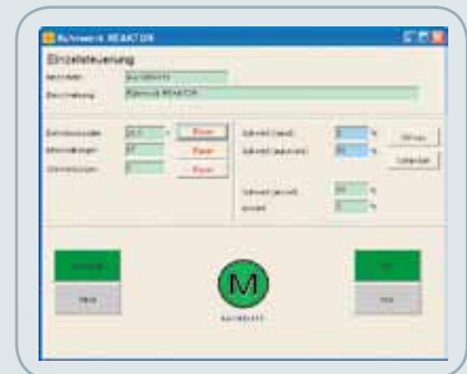
Popup-Fenster „Handbetrieb“ in Anlagensvisualisierung KVis
